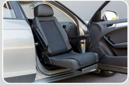
Cette embase pivotante électrique est programmable et permet de faire pivoter le siège et de le faire sortir totalement du véhicule (sans montée descente). La course programmable assure un maximum d'espace pour les jambes et pour la tête.
