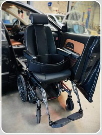
Le Turny Manual est une embase pivotante manuelle qui permet de faire pivoter le siège de la voiture. Vous y encrez l'embase Carony, ce qui permet une utilisation en fauteuil roulant et évite tout transfert.
