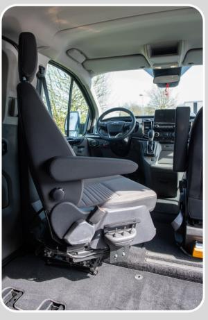
Ce système a 6 fonctions, il peut avancer/reculer, monter/descendre, ainsi que pivoter vers la gauche/droite. Cela permet de faire son transfert vers le siège conducteur ou passager à l'intérieur du véhicule.
