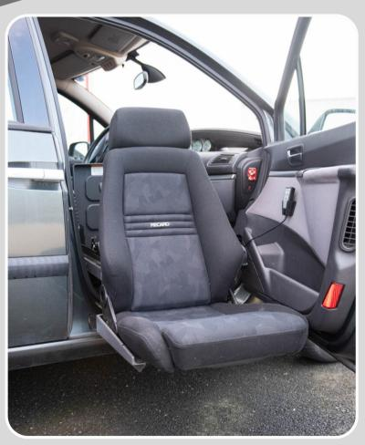
Le Turny Evo est équipé d'un pivotement et d'un levage électrique programmable. Celui-ci sort entièrement du véhicule en pivotant, il monte et descend une fois sorti.
