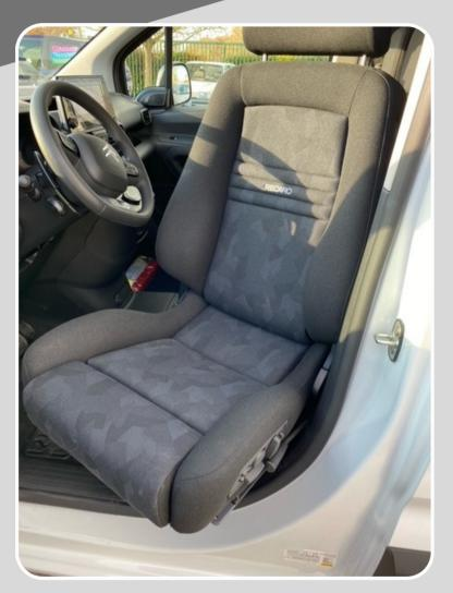
Cette embase pivote et sort le siège de quelques centimètres vers l'extérieur. Le pivotement peut être manuel ou électrique. Ce système facilite le transfert du fauteuil roulant au siège conducteur ou passager.
